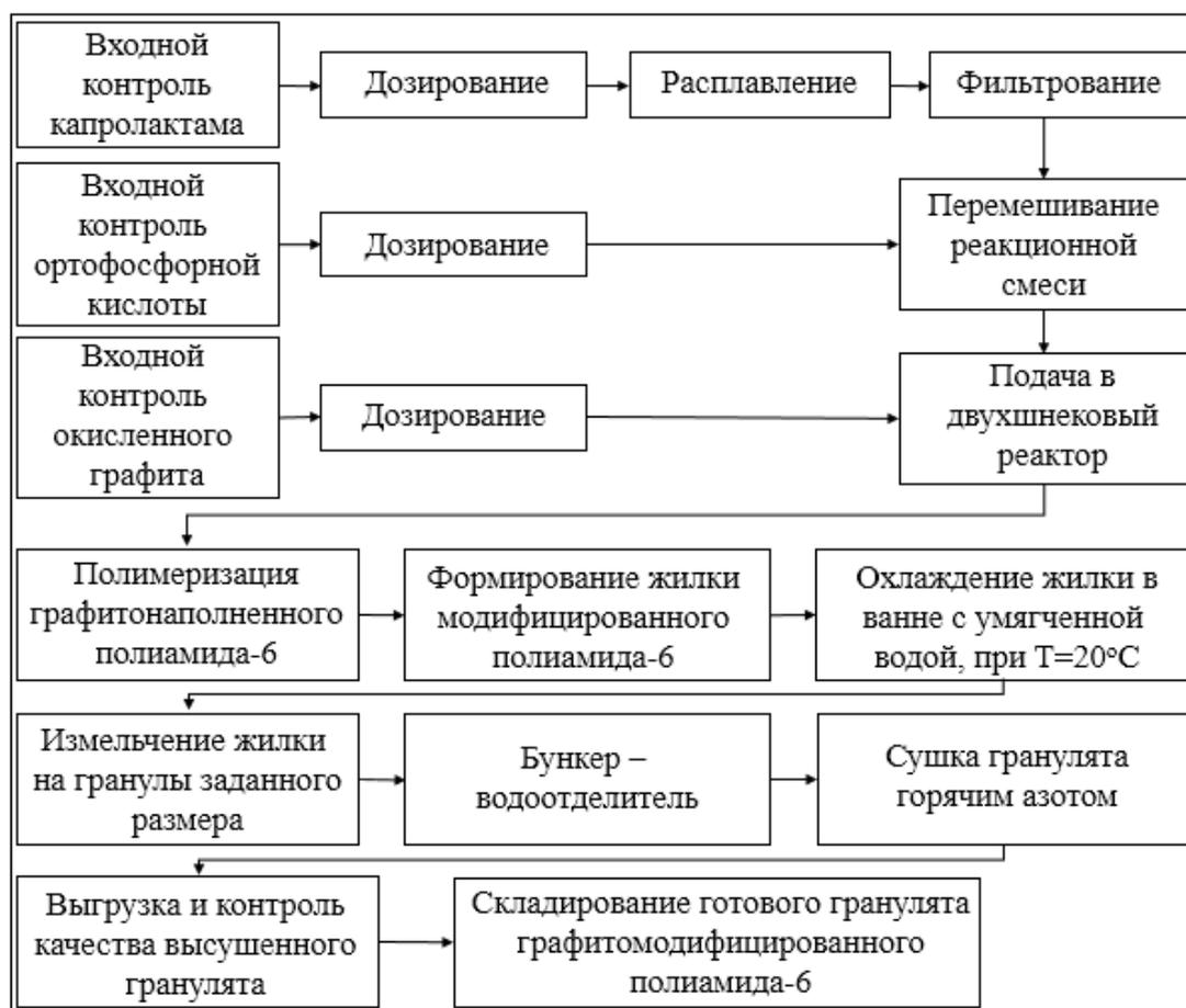
Рисунок 5.2.1 – Функциональная схема получения гранулята графитомодифицированного полиамида-6
