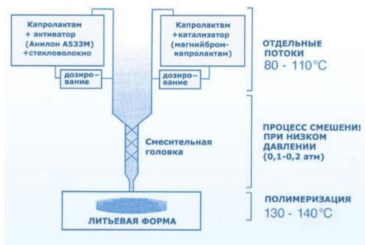
Рисунок 1.1.2 – Схема получения ПА-6 с использованием RIM-технологии
